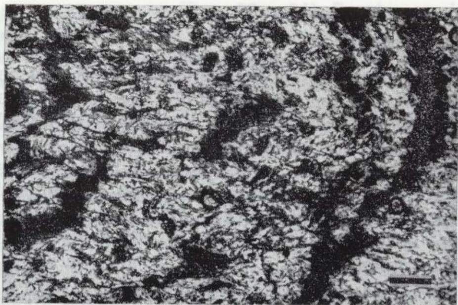
Figura 93.—Pliegue al que se asocia el clivaje de crenulación dominante ( S_3 ) del Anticlinal Central, que deforma una fábrica previa ( S_2 ). Escala de la barra, 0,1 mm.
